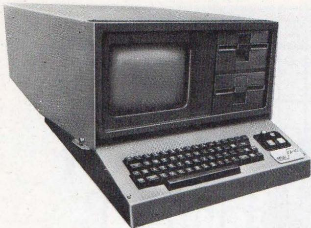
Figura 1 — Il sistema VDP-40 della IMSAI. Il processore è l'8085. Il bus di sistema è l'S-100. Può essere utilizzato come terminale intelligente o come business computer. È supportato da IMDOS (IMSAI's Multi-Disk Operating System). Lavora in BASIC (quattro versioni) e in FORTRAN IV.
